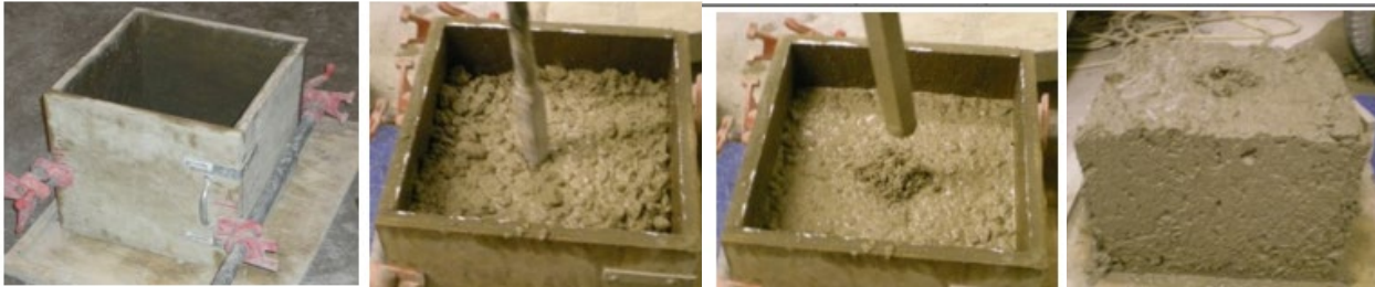
AASHTO TP 137 – Box Test Procedure
